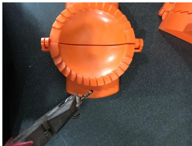
Rajah 3.2: Cara menebuk acuan menggunakan paku yang telah dipanaskan.
