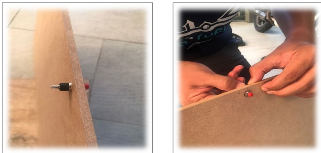
Rajah 3.3: Pemasangan suiz buzzer di lubang tersebut
