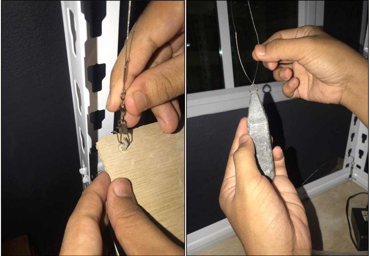
Rajah 3.8: Proses ikat dan sangkut steel wire dan memasang pemberat di hujung steel wire
