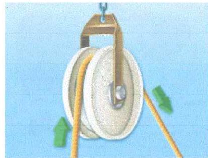
Pulley adalah suatu alat mekanis yang digunakan sebagai sabuk untuk menjalankan sesuatu kekuatan alur yang berfungsi menghantarkan suatu daya. Cara kerjanya sering digunakan untuk mengubah Arah dari gaya yang diberikan, Mengirimkan gerak rotasi, Memberikan keuntungan mekanis apabila digunakan
