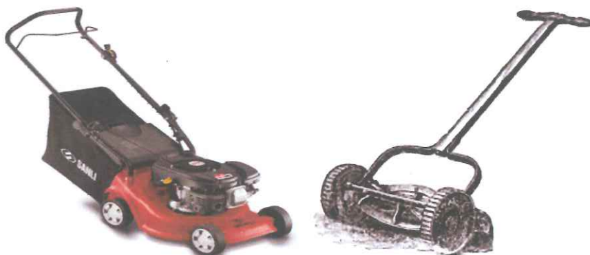
Rajah 2.0: Pemotong silinder dan jenis putar
